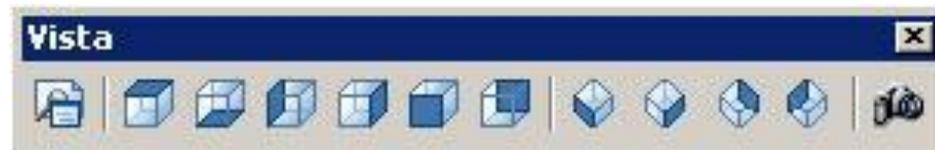
**Autocad crea automaticamente le viste standard e fornisce la possibilità di usare più viste contemporaneamente.**
