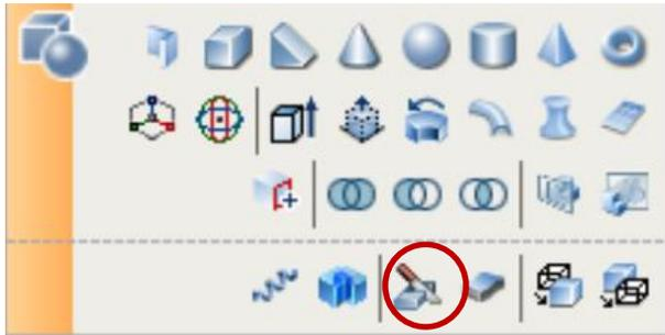
Trancia un solido mediante un piano o una superficie.
