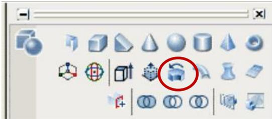
**Rivoluzione:** Crea un solido o superficie 3d generato tramite la rotazione di una curva aperta o chiusa quale una polilinea o simili intorno ad un asse, secondo un determinato angolo. L'asse viene definito inserendo 2 punti e l'angolo avrà un valore definito in gradi sessagesimali.
