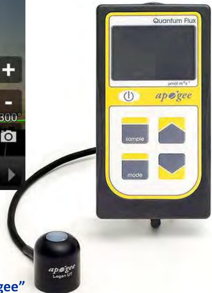
Misura dell'intensità della PAR ( $\mu\text{mol}/\text{m}^2/\text{s}$ ): "Apogee"
