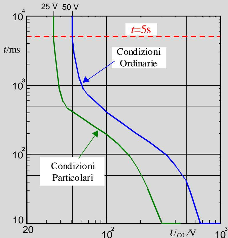
Analizzando il circuito che si viene a creare nelle varie condizioni, la curva della precedente slide è "tradotta" da corrente-tempo a tensione-tempo.
