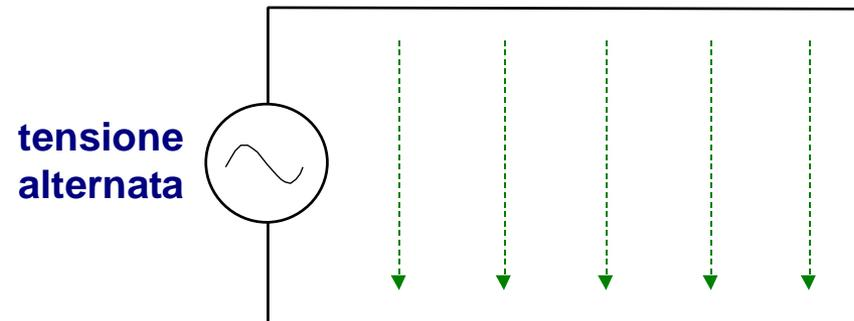
La corrente, come continuo flusso di cariche (**corrente di conduzione**), può solo circolare in circuiti chiusi
